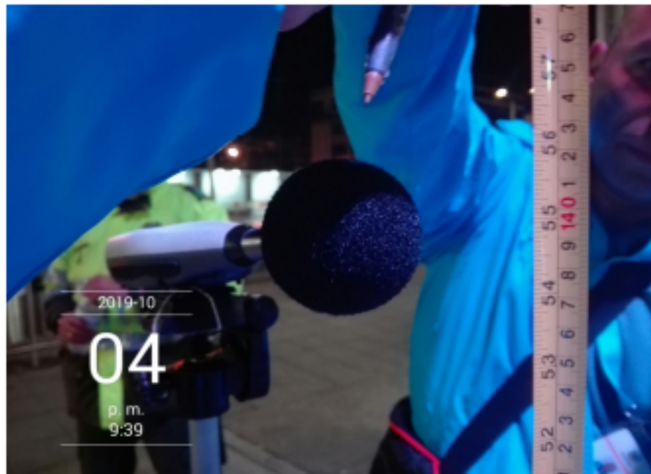
Fotografía No 7. Detalle de la altura del sonómetro, a 1,20 m del suelo teniendo en cuenta el escalón.
